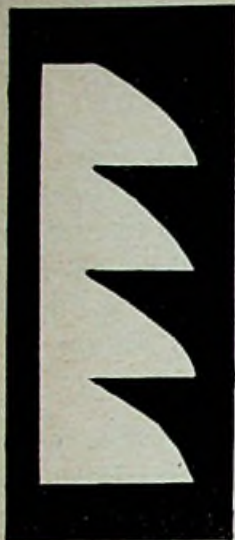
Fig. 2. Beeld eener kiptrilling met de amateur-oscillograaf.
